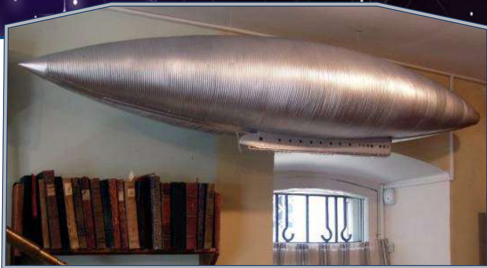
Модель оболочки аэростата из гофрированного металла (дом-музей К. Э. Циолковского в Боровске)
