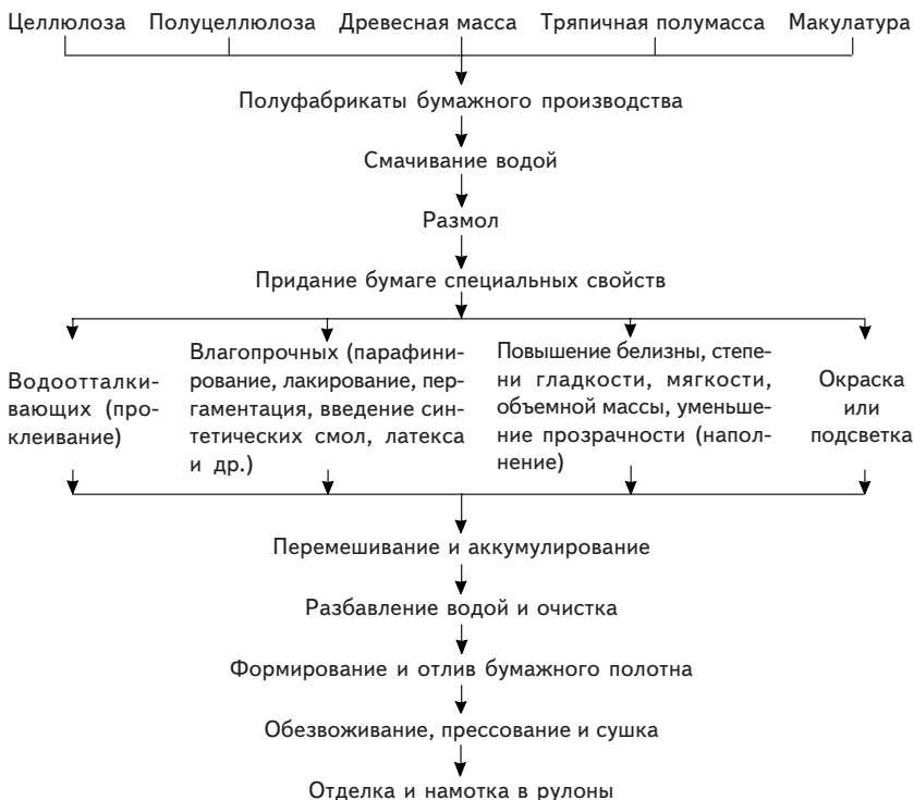
Рис. 12.5. Технологический процесс производства бумаги
