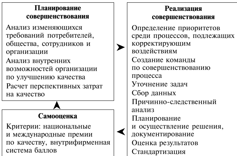
Рис. 30. Цикл всеобщего управления в системе TQM
