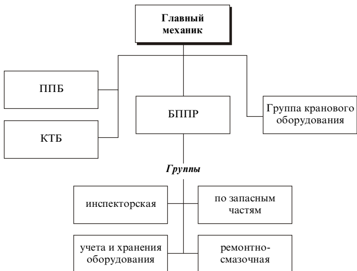
Рис. 14. Структура отдела главного механика на крупном предприятии: ППО — планово-производственное бюро; КТБ — конструкторско-технологическое бюро; БППР — бюро планово-предупредительных ремонтов
