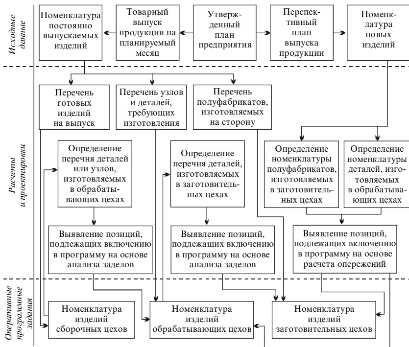
Рис. 42. Последовательность этапов установления номенклатуры изделий, подлежащих включению в оперативные программы цехов
