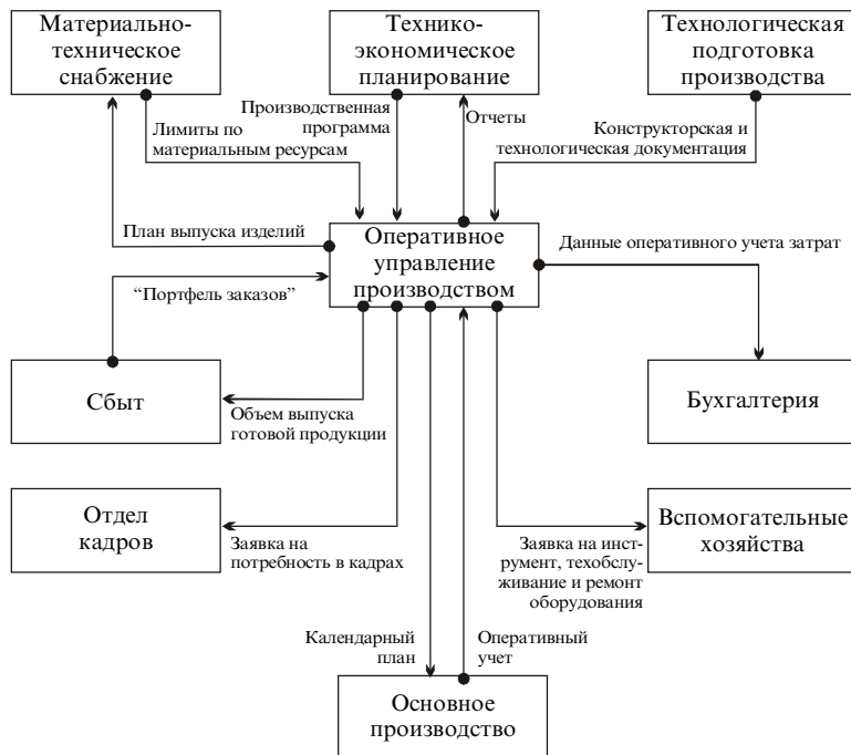
Рис. 39. Укрупненная схема информационных потоков между ОУП и другими службами предприятия
