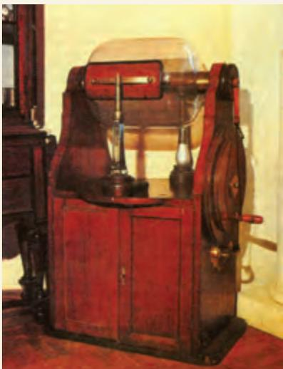
Рис. 1. Электростатическая машина
