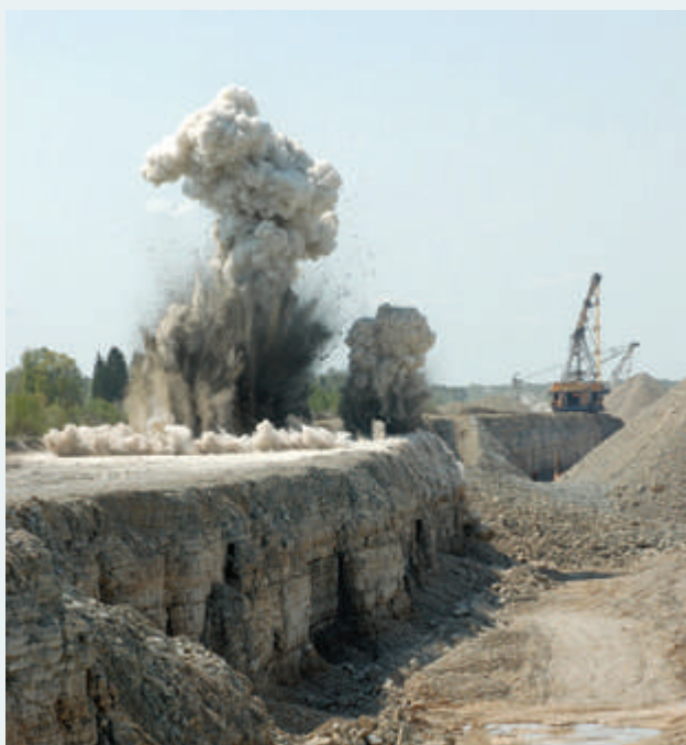
Нитрат аммония – составная часть взрывчатки при разработке горных пород
