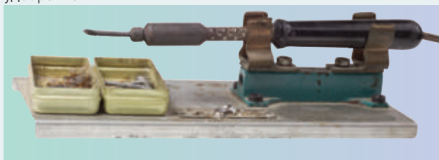
Хлорид аммония (нашатырь) используется при пайке металлов
