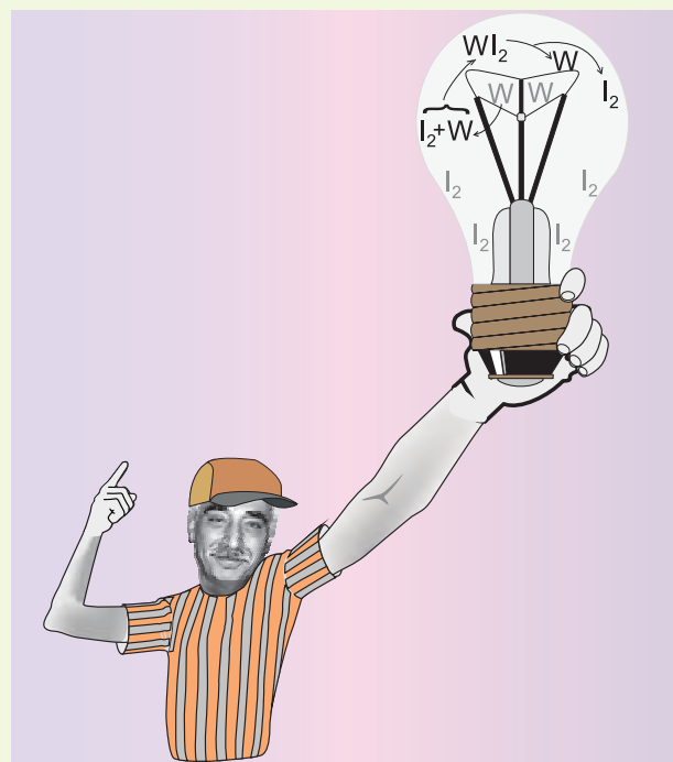
Рис. 4. Возвращение вольфрама на спираль в галогенной лампе накаливания
