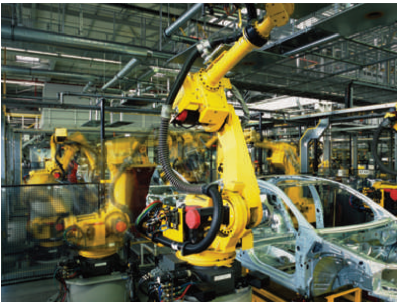
Южная Корея. Автомобильный завод, роботы выполняют точечную сварку
