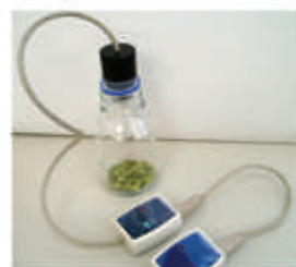
Рис. 3. Изучение дыхания семян с помощью модуля содержания кислорода
