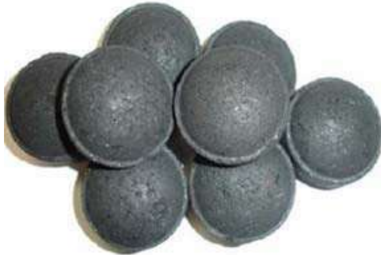
Рисунок 6.6 – Зразки брикетів з мулів очисних споруд
