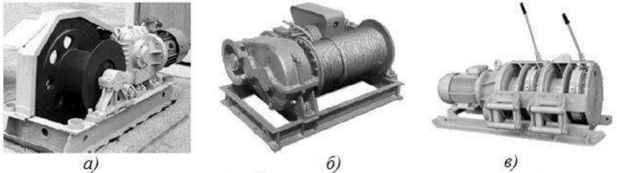
Рис. 3.5. Лебідки з канатним тяговим органом: а), б) однобарабанні; в) двохбарабанна
