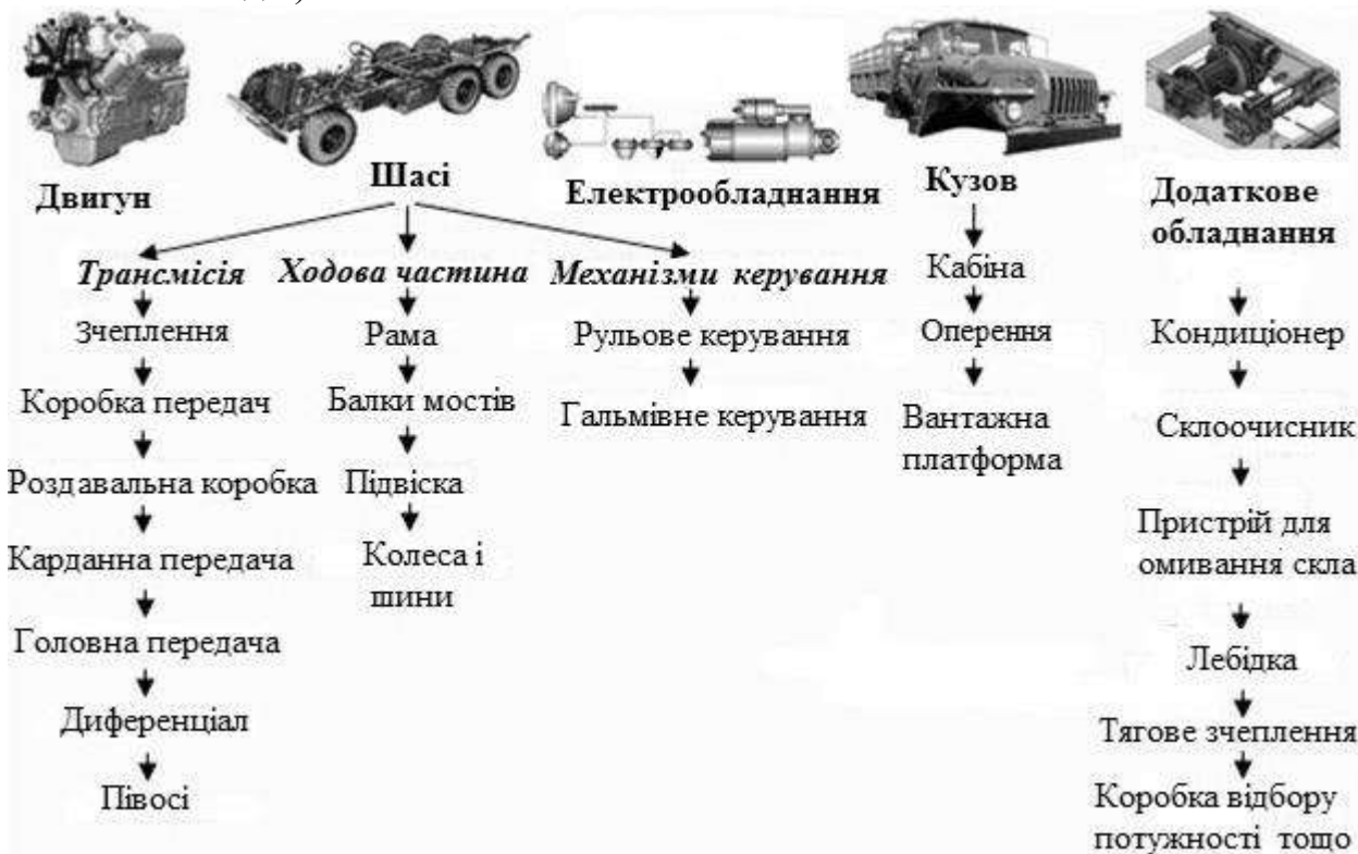
Рис. 1.2. Загальна будова вантажного автомобіля
