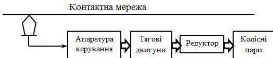
Рис.5.5. Структурна схема передачі потужності у електровозі
