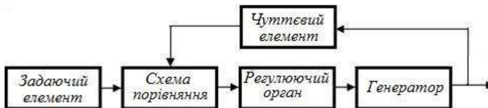
Рис. 1.36. Структурна схема регулятора напруги
