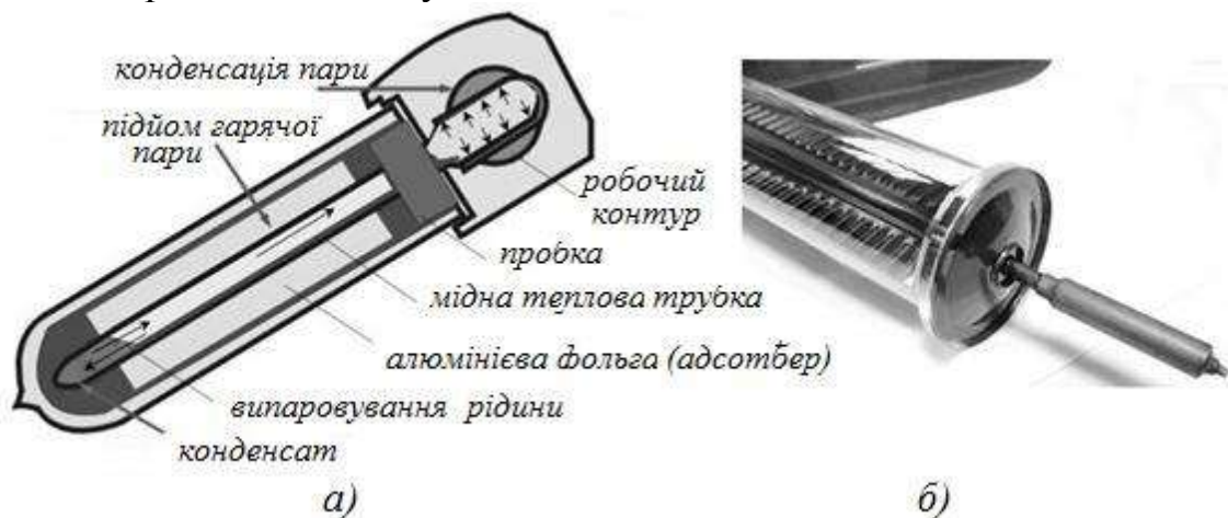
Рис. 3.81. Схема вакуумної трубки «Heat pipe»(а) та її загальний вигляд(б)
